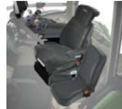
O assento super-conforto Evolution Dynamic tem suspensão pneumática e controlo climático ativo assim como extensão do encosto lombar.
