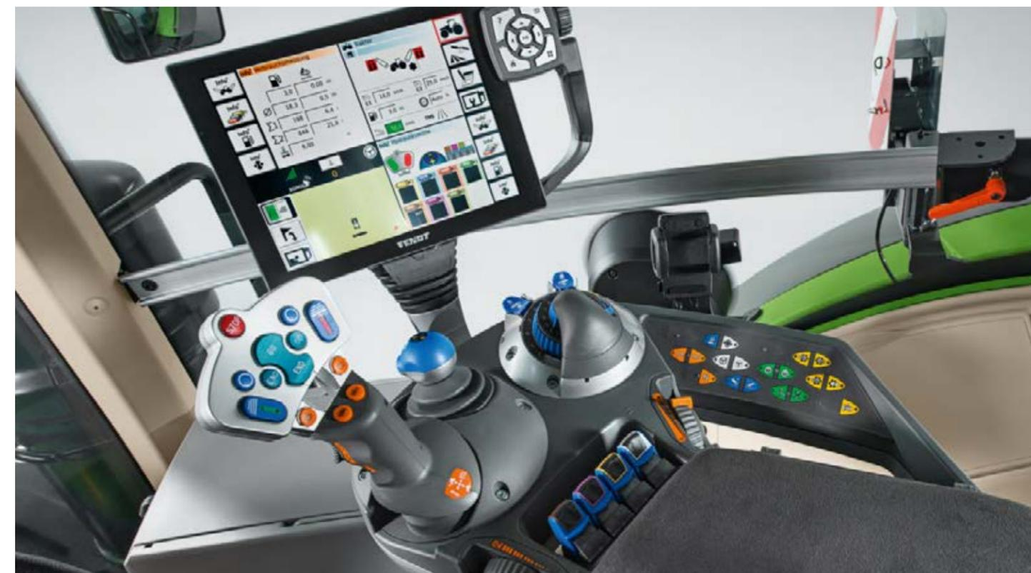
Graças ao centro de controlo ergonómico que compreende o Varioterminal 4-em-1, o joystick multifunções, a alavanca monocomando em cruz, o elevador EHR, o controlo de válvula e o teclado de membrana - terá tudo sob controlo.
