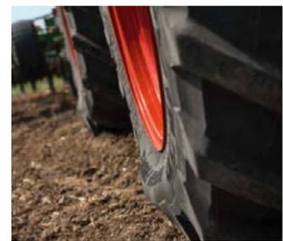
O sistema de regulação da pressão dos pneus perfeitamente integrado VarioGrip controla a pressão dos pneus de 0,6 a 2,5 bar em poucos minutos. A pressão ótima dos pneus economiza combustível, protege o solo e aumenta a tração.
