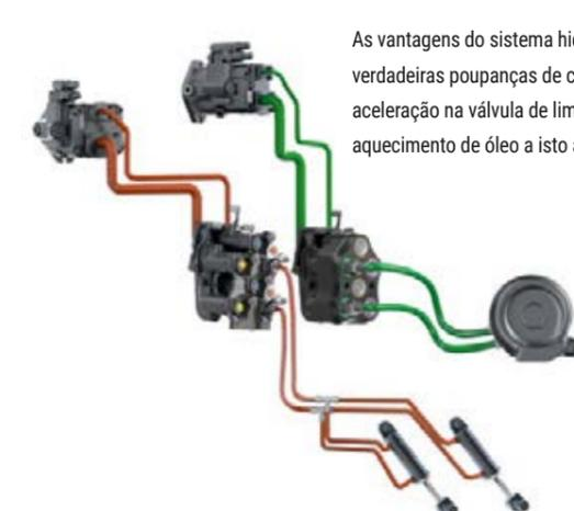
As vantagens do sistema hidráulico de duplo circuito são evidentes: verdadeiras poupanças de combustível uma vez que as perdas de aceleração na válvula de limitação de pressão, e o desnecessário aquecimento de óleo a isto associado, foram reduzidos.
