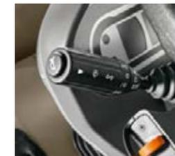
Como todos os Fendt, o Fendt 1000 Vario facilita o trabalho diário através de pequenos detalhes práticos, como a reposição automática dos piscas: o trator pisca automaticamente até que a viragem tenha sido completada.
