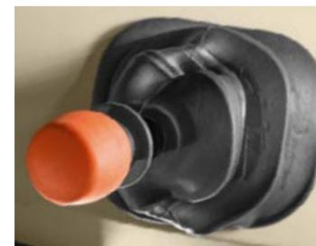
Assistente no travão de mão na posição automática: O travão de mão é ativado automaticamente.
