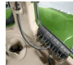
O passa-cabos integrado permite uma orientação ajustada dos cabos através da janela traseira, proteção contra a sujidade, água e ruído. Deixa de haver emaranhados de cabos: Todos os cabos no guia de cabos estão na coluna C.
