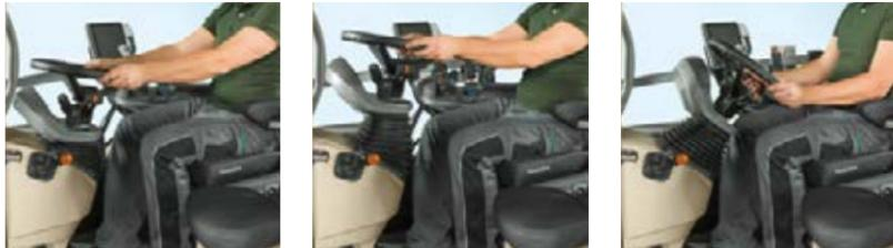
Para um conforto operacional aumentado, o cockpit oscila em conjunto com o volante da direção. Fácil ajuste do volante através de um pedal separado, mãos-livres para ajustamento.
