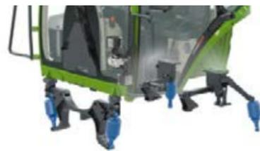
A suspensão pneumática da cabina conforto, com 4 rolamentos e nivelamento integrado reduzem as vibrações ao mínimo.
