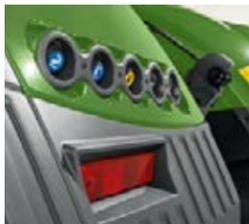
Com os controlos externos das válvulas, pode acionar o elevador traseiro, uma válvula e a TDF diretamente a partir do guardalamas traseiro.
