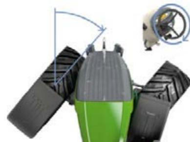
Com o VarioActive, faz uma volta completa da direção com apenas uma volta do volante.
