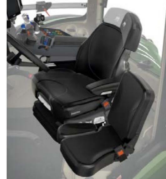
O assento conforto do passageiro está formado ergonomicamente e tem um acolchoamento adicional. Quando rebatido, torna-se numa prática mesa com um fixador para papéis.
