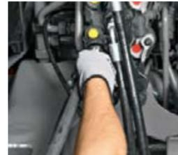
As válvulas de retenção com auto-fechamento protegem contra contaminação e permitem o acoplamento com uma única mão.
