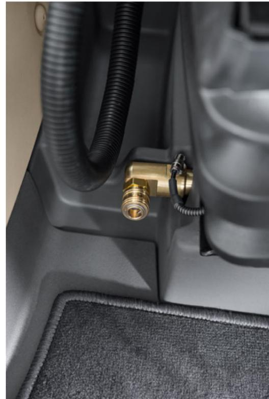
A cabina é limpa rapidamente: Os assentos do condutor (Assento Super Conforto Evolution) têm uma conexão prática para uma mangueira de ar comprimido, que pode ser usada para limpar a cabina.
