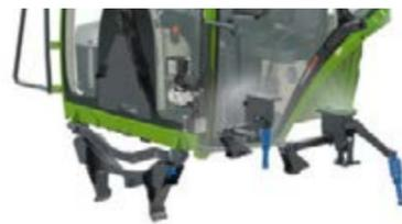
A suspensão mecânica da cabina apoia-se em dois rolamentos cónicos à frente e em dois elementos de amortecimento pneumático atrás.
