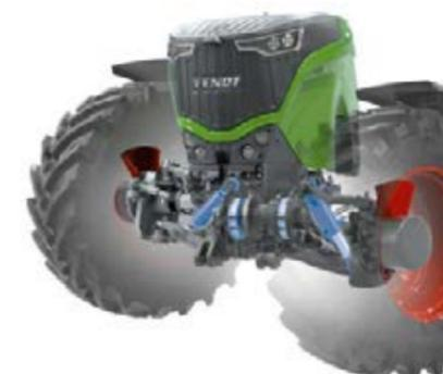
Eixo frontal com suspensão das rodas independente com auto-nivelamento e travão das rodas simples
