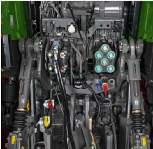
O Fendt 1000 Vario pode ser customizado à sua medida. A traseira completamente equipada tem todas as conexões e funções, tais como potência extra, tomada ISOBUS, retorno traseiro, TDF e elevador traseiro.
