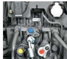
Com os acoplamentos DCUP, pode acoplar todas as válvulas hidráulicas sob pressão de ambos os lados. A alavanca de alívio de pressão permite um fácil acoplamento.
