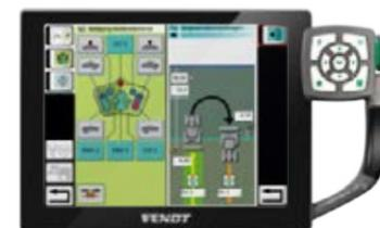
As funções para o controlo de implementos Variotronic™ (ISOBUS) e gestão de cabeceiras podem ser atribuídas à alavanca multifunções conforme necessário. Em combinação com o sistema de condução automática VarioGuide, o Variotronic™ automático permite a ativação automática de sequências na cabeceira.
