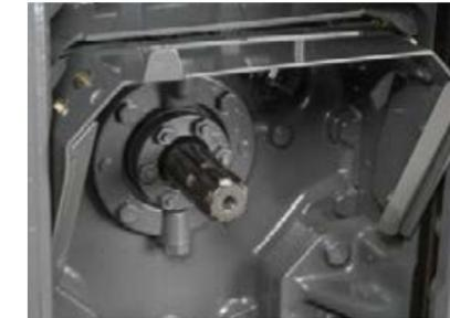
Com os controlos externos das válvulas, poderá controlar o elevador traseiro, uma válvula e a TDF diretamente no guarda-lamas traseiro. Utilizando os controlos externos para a TDF traseira, um regime de motor pré-configurado pode ser alcançado automaticamente.
