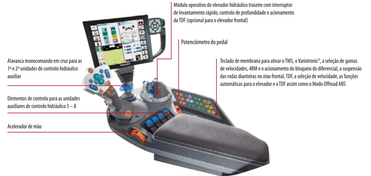
Alavanca monocomando em cruz para as 1ª e 2ª unidades de controlo hidráulico auxiliar
