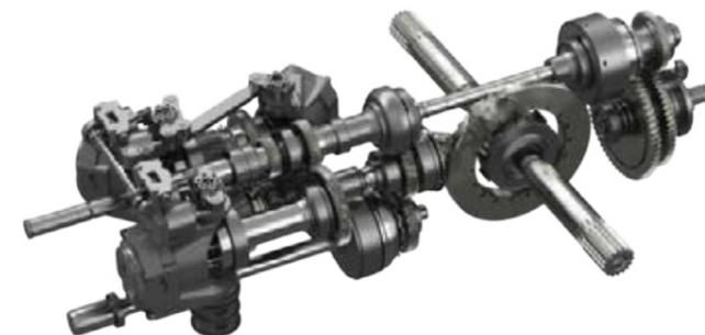
A transmissão Fendt Vario é uma transmissão de divisão de potência hidrostática-mecânica. Com uma velocidade cada vez maior, a proporção de energia mecânica transmitida através do conjunto de engrenagens planetárias aumenta. Os hidróstatos podem ser colocados a 45 graus e têm uma pressão operacional elevada de 550 bar no máximo – isto garante uma eficiência excepcional.
