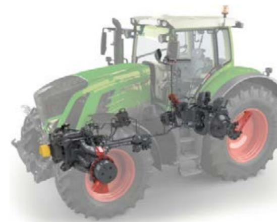
O sistema integral de regulação da pressão dos pneus VarioGrip adapta a pressão dos pneus num curto período – mesmo durante a condução. Isto é alcançado através da união rotativa integral, que é desenhada para durar toda a vida útil do trator. O ar é fornecido através de um duplo compressor refrigerado a água, bem como o equipamento de válvula próprio do veículo.
