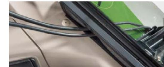
■ A Fendt oferece uma solução inteligente para os cabos que passam pela parte traseira do trator dentro da cabina. Os cabos podem ser guiados através da calha, independentemente do tipo de secção transversal que eles tenham. A janela traseira pode ser fechada, de forma que a poeira, a sujidade, a água e o ruído fiquem de fora.
