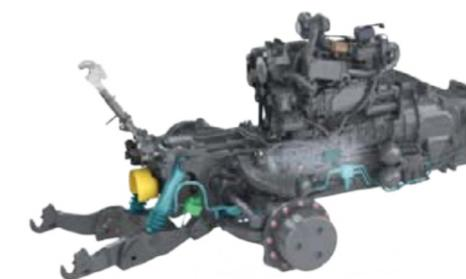
O elevador conforto frontal no Fendt 900 Vario tem controlo de alívio de carga opcional. Permite transferir o peso da alfaia para o trator. Isto é especialmente vantajoso quando trabalha com uma gadanheira frontal ou com implementos de manutenção de inverno, porque reduz a carga no implemento e aumenta a estabilidade. A pressão de alívio pode ser ajustada no Varioterminal.
