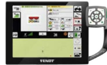
O VarioDoc permite a transferência de dados sem fios do Varioterminar à base de dados de campo. O VarioDoc Pro regista continuamente a posição e dados da máquina e a transferência de dados é possível através da rede móvel.
