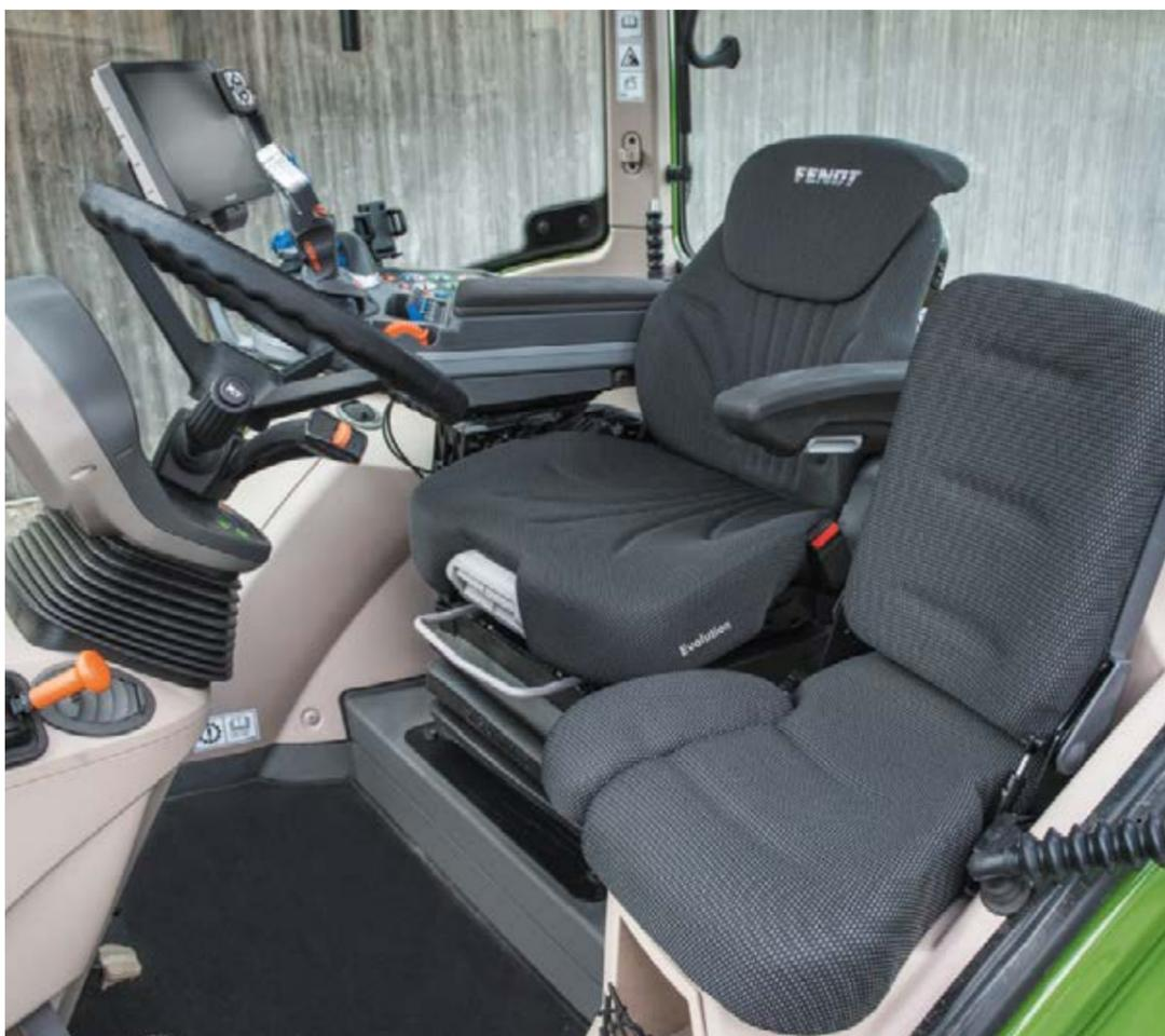
■ Para a melhor posição de assento, o volante de direção e o cockpit deve estar à altura e ângulo de direção corretos. É esta a razão por que toda a cabine do Fendt 500 Vario pode ser ajustada individualmente, tudo através do pedal.
