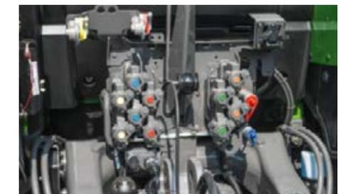
Os acoplamentos hidráulicos são deslocados e codificados por cores na parte traseira para facilitar o acoplamento com uma mão e a acessibilidade perfeita. As tampas anti-poeira são de fechamento automático com um mecanismo de mola.
