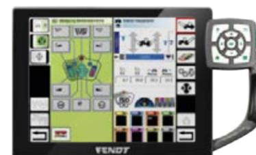
Controlo de implementos ISOBUS no terminal e joystick: Utilizando o interface ISOBUS opcional, todos os implementos capacitados para ISOBUS podem operar com o Varioterminal, portanto os terminais de implementos adicionais não são necessários. O joystick Vario também oferece até 10 botões de controlo. Isso permite-lhe controlar facilmente o implemento com o joystick multifunções.
