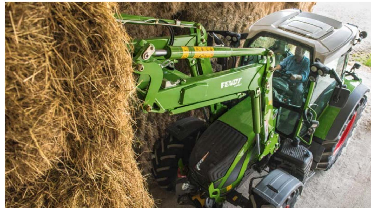
A janela panorâmica dianteira completa oferece um amplo ângulo de visão de 77° e uma visibilidade total do carregador frontal elevado e dos arcos das rodas.
