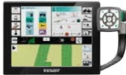
O Fendt VarioGuide permite-lhe manter-se na via, com uma precisão de +/- 20 cm (VarioGuide Standard) ou +/- 2 cm (VarioGuide RTK). Pode usar um recetor e um serviço de correção à sua escolha.
