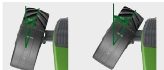
■ A estabilização de cargas de impacto integrada impede o trator e a alfaia de saltar, uma vez que contraria ativamente os movimentos através do sistema hidráulico. Reduz os movimentos de ressalto para que possa beneficiar de uma maior segurança de direção e maior conforto de condução.
