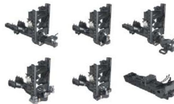
□ Para o 500 Vario, pode escolher entre 6 sistemas de fixação inferiores: Barra de tração retrátil Cat. 3 e barra de tração com deslocamento lateral, engate, Piton Fix padrão e pesado e acoplamento de cabeça esférica.
