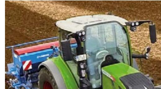
O recetor VarioGuide está excepcionalmente bem protegido e totalmente integrado no teto. Sem peças penduradas ou cabos guiados externamente, a tecnologia está particularmente bem protegida contra galhos suspensos, mas também contra roubo.
