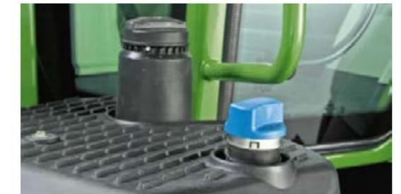
O 500 Vario possui um depósito de gasóleo com capacidade de 298 l, que pode trabalhar extensivamente sem parar. O depósito de AdBlue está totalmente integrado no depósito de gasóleo e comporta 31 litros. Ambos os depósitos podem ser atestados do mesmo lado.
