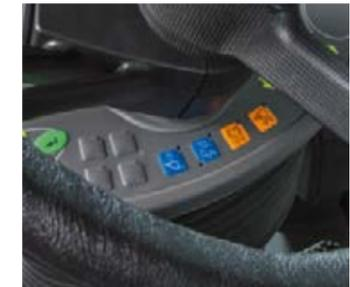
A alavanca monocomando em cruz, instalada de série, oferece controlo sensível sem que precise alcançar mais de duas válvulas hidráulicas. As funções complexas da alfaia podem ser controladas com os terceiro e quarto circuitos hidráulicos opcionais. Estes são ativados e controlados por botões de pressão na alavanca monocomando em cruz.
