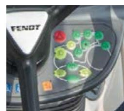
■ A iluminação é facilmente ajustada graças às suas teclas simples e diretas. Com o sistema inteligente de um botão, todas as luzes podem ser ligadas e desligadas com um único toque no teclado – especialmente prático quando muda frequentemente de campo e durante a condução em estrada no escuro.
