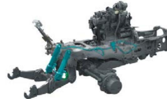
O elevador dianteiro está totalmente integrado e fica firme contra o veículo. Isso mantém as máquinas acopladas altamente manobráveis. Os braços inferiores têm uma aderência inferior particularmente boa e podem ser articulados para estacionamento. Os foles protegem os cilindros de levantamento contra o impacto de pedras. O amortecimento de vibrações montado de série impede o ressalto e garante uma condução e conforto seguros.
