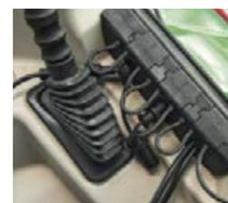
■ O passador de cabos integral evita que a sujidade, a água e o pó entrem na cabine. A vedação também isola do ruído.
