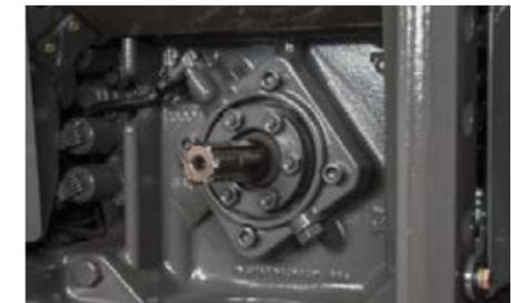
A transmissão Fendt Vario é uma transmissão de divisão de potência hidrostática-mecânica. O eixo TDF gira livremente.
