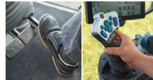
Pedal de condução ou controlo por joystick: O modo de condução pode ser selecionado individualmente: A velocidade pode ser controlada através do pedal ou do joystick. A direção de condução pode ser alterada com o joystick ou com a alavanca do inversor com função stop and go integrada.
