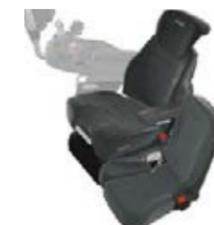
□ Para além das características do assento super conforto, o assento super conforto Evolution Dynamic possui amortecimento horizontal lado a lado e controlo da climatização. A suspensão pode ser ajustada pneumáticamente por ar comprimido do compressor do veículo, pelo que a suspensão do assento pode ser perfeitamente adaptada ao peso do condutor.
