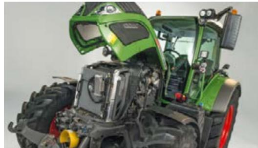
O compartimento do motor é facilmente acessível para inspeção e manutenção, mesmo com acessórios de carregadores frontais. O capô tem duas partes laterais separadas para facilitar a abertura.
