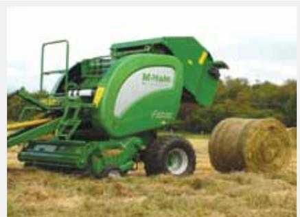
Cuando la paca está terminada se expulsa de la cámara, la rampa de descarga de gran resistencia garantiza una separación adecuada entre la máquina y la paca. El diseño del eje ofrece una mayor distancia al suelo y estabilidad en terrenos difíciles.
