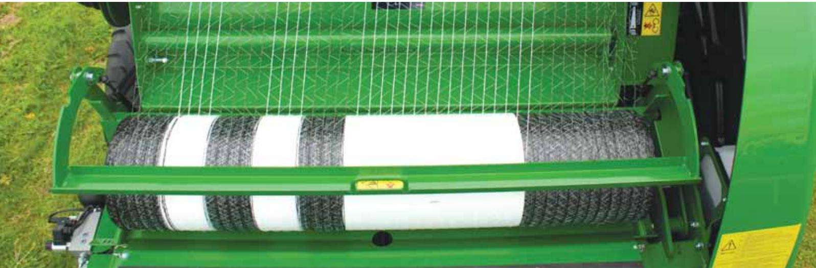
Se ha diseñado un nuevo atador de malla de alto rendimiento para la gama F5000.
