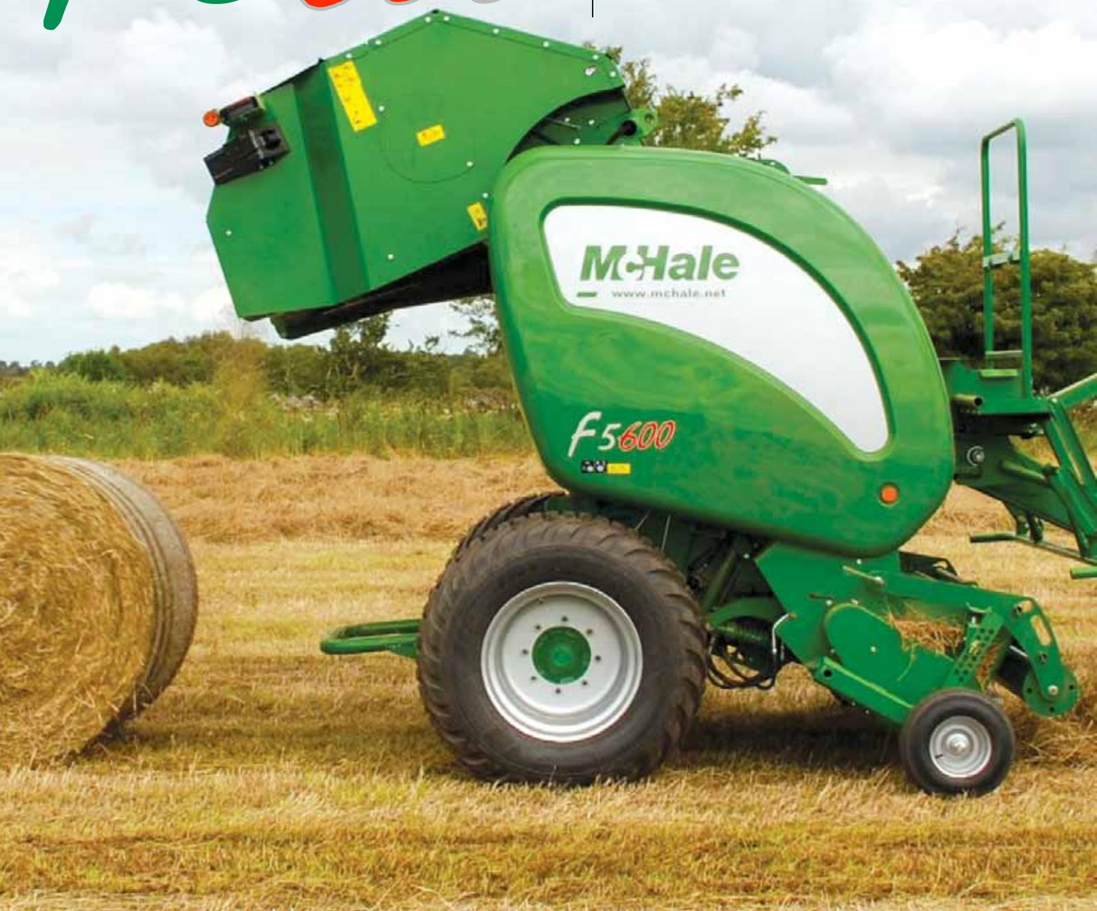
La Mchale **F5600** está equipada con una válvula de control Load Sensing, que hace que todo el proceso de empacado sea automático. La máquina dispone de un picador de 25 cuchillas.
