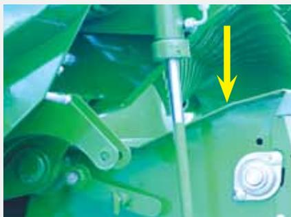
Al producirse un bloqueo, el sonido del embrague avisa al operario que puede bajar hidráulicamente el banco abatible desde la cabina del tractor.
