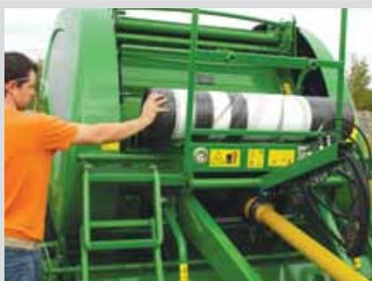
En la gama empacadora F5000 se optimizó la carga de malla por el sistema de carga "rock and roll". El usuario solo tiene que sacar el envoltorio del rollo de malla de reserva en la plataforma de la máquina y bascularla sobre el atador de malla. Hay espacio para el almacenamiento de otro rollo de reserva en la plataforma.
